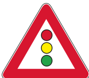
Annnonce de feu tricolore Lichtzeichenanlage
